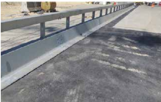
Underlag: VarioGuard er testet plassert på asfalt.
